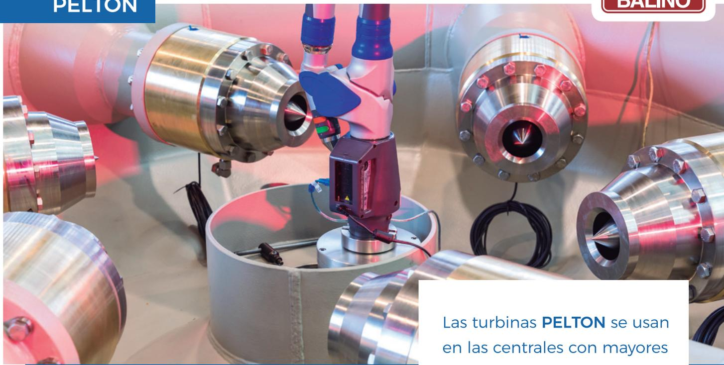
Las turbinas **PELTON** se usan en las centrales con mayores saltos, generalmente a partir de 100 m.
